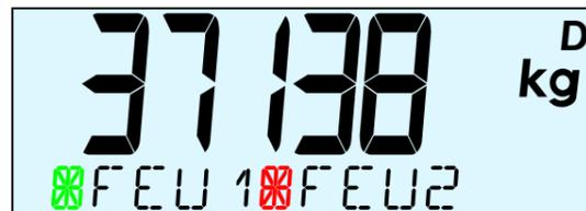
: Autorización de la pesada según el estado de un contacto (célula de posicionamiento del vehículo, contacto con llave, etc.)
