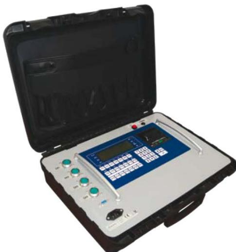
Apto como pesa ruedas o para pesar objetos con varios puntos de apoyo. Especialmente indicado para el pesaje y el cálculo de las coordenadas el centro de gravedad de vehículos, camiones, aviones, containers, etc. Visualización simultánea del peso de cada plataforma conectada y de la suma. Homologación CE-M (OIML R-76/EN 45501). Siempre y cuando el número de ruedas sea igual al número de plataformas. Máximo 8 unidades.
